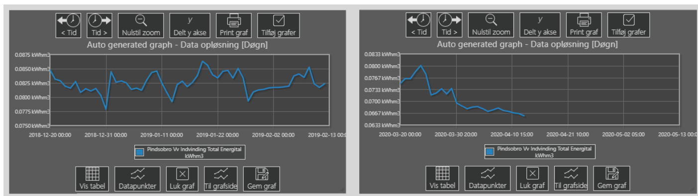
Graferne viser energiforbruget kWh/m 3 før og efter implementering af SmartRåvandsstyring på kildepladsen ved Pindsobro.
